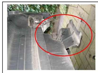
Rechts: Verkleidung Unterboden lösen (2xTX25) und nach unten biegen
