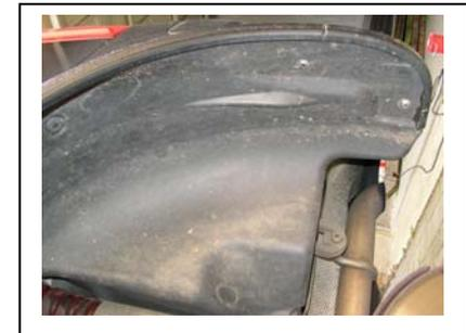
Wagen aufbocken, Rad abnehmen und 5 Torx (TX25) entfernen
