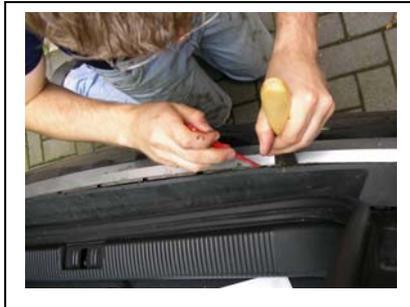
Abdeckung zw. Chromleiste & Kofferraumkante entfernen (6 Klipse)
