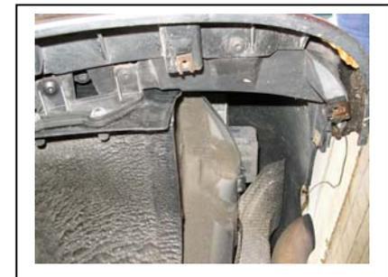
14 Torx (TX25) im Radkasten entfernen
