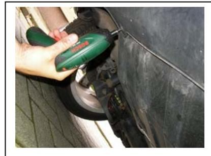
Torx am Unterboden entfernen (TX20, TX25)
