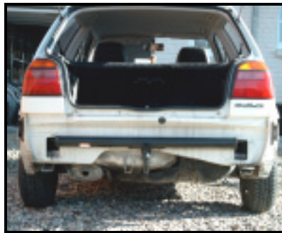
Anbau der AHK
