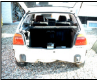
Abbau der Stoßstange
